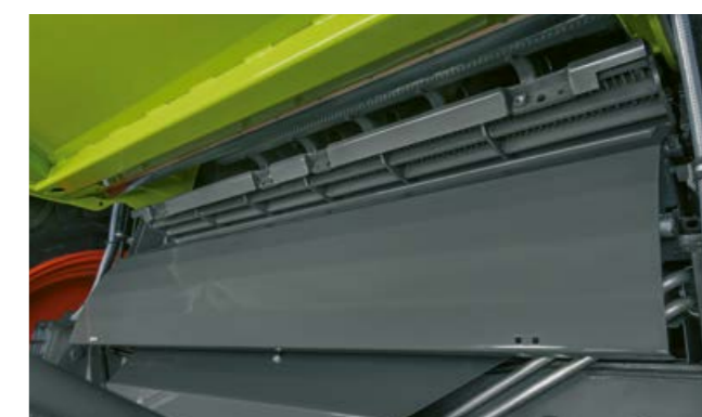
Brosegmentet kan enkelt trekkes ut gjennom steinkassen.
