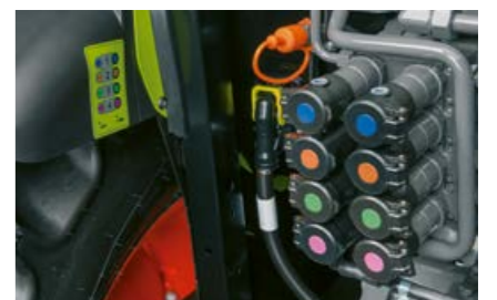
Tilkoblingene bak er lett å identifisere ved fargekoding og klebmerkene plassert i nærheten.
