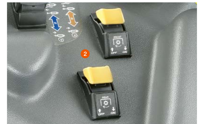
2 Kraftuttaket foran og bak kan enkelt aktiveres med et trykk på en knapp.
