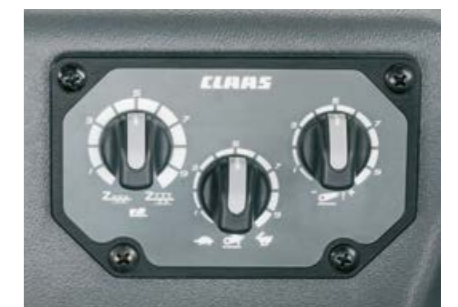
Du kan stille inn trekkraftkontroll, senkehastighet og løftehøydebegrensning komfortabelt på den høyre konsollen.
