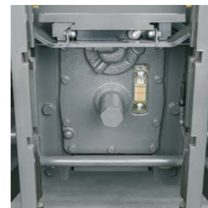
Du kan sjekke oljenivået i transmisjonen og hydraulikksystemet via et nivåglass ved siden av kraftuttakstappen bak.
