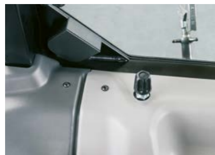
Maks. oljemengde til mekanisk betjent hydraulikkventil nr. 3 kan begrenses med et håndtak fra førerhuset.
