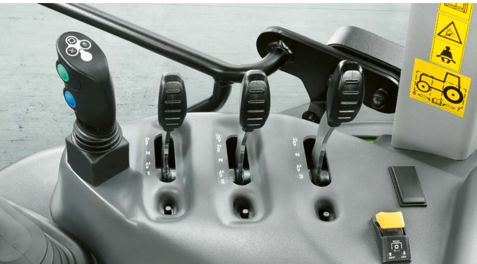
Maks. oljemengde til mekanisk betjent hydraulikkventil nr. 3 kan begrenses med et håndtak fra førerhuset.
