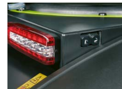
Du kan betjene løftearmene bak utvendig på begge baksjermene.
