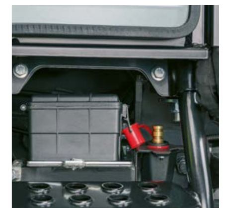
AXOS 200 gjør hverdagen enklere for deg med mange intelligente løsninger som ekstra batteritilkoblinger på høyre side av førerhuset.
